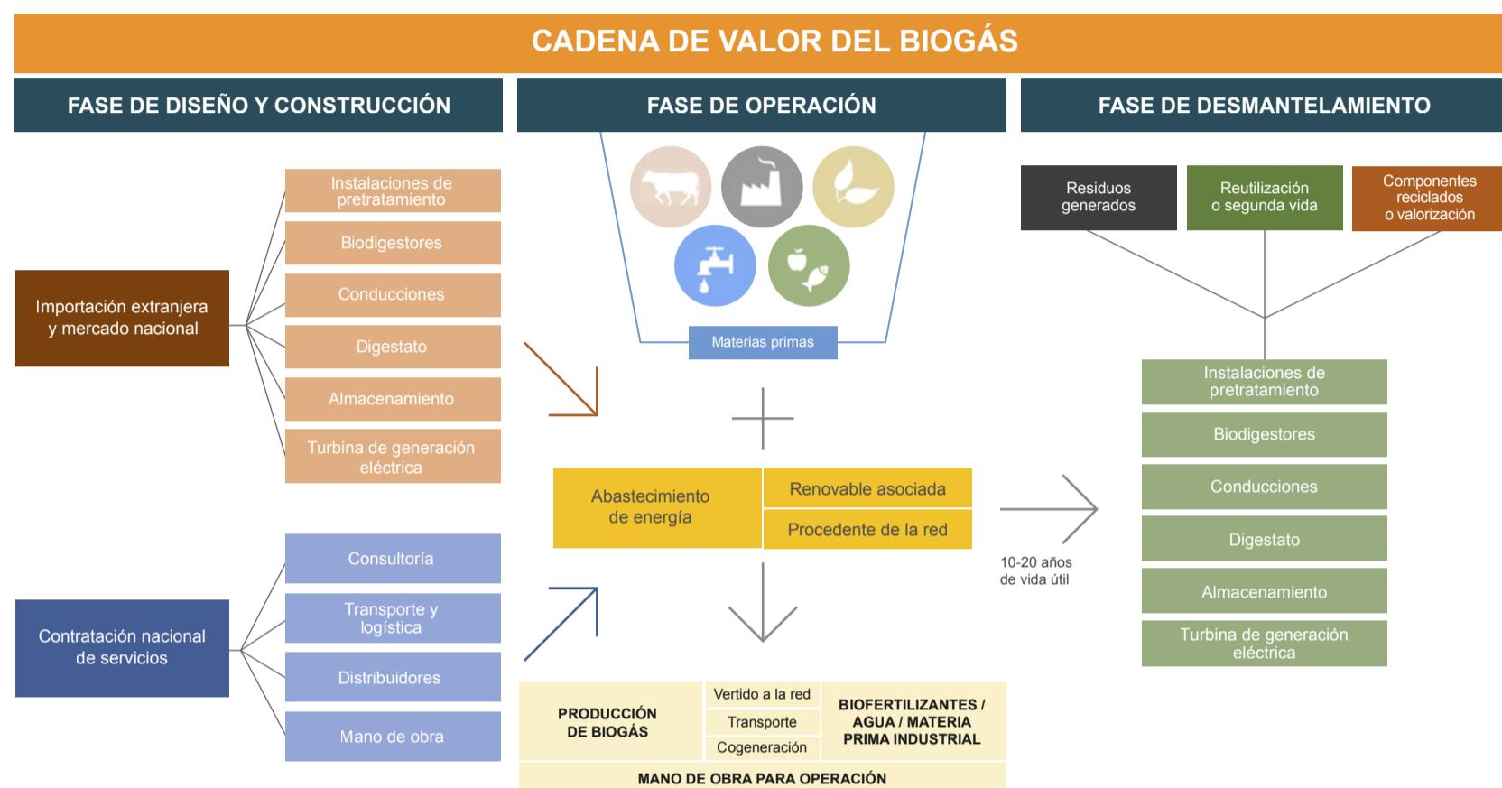
Figura 9 – Cadena de valor del biogás. Fuente: elaboración propia, 2024
